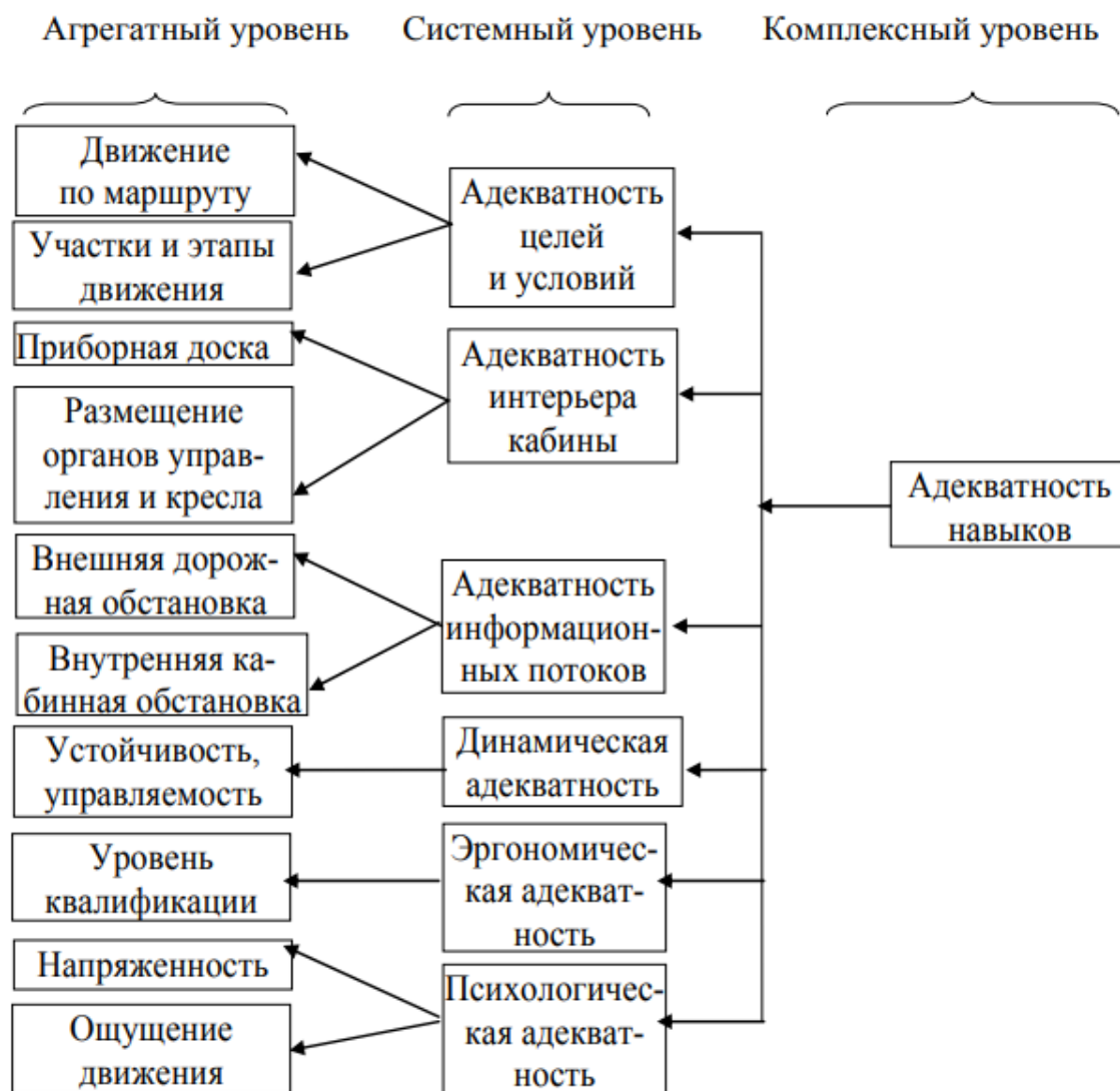
Рисунок 2 - иерархическая структура адекватности автомобильного тренажера
