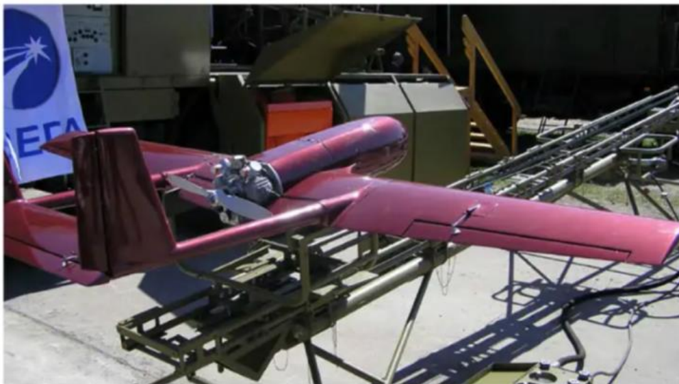
Рисунок 1.1.1 — Первый прототип БПЛА 9М62 «Типчак». БПЛА самолётного типа
