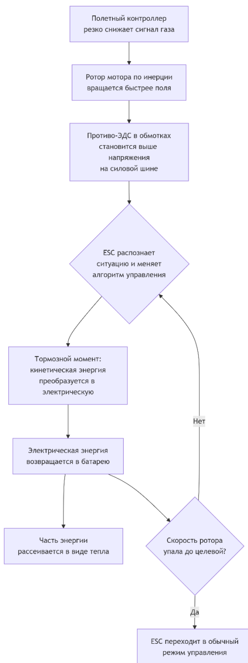
Рисунок 2.3.2 — Диаграмма перехода с режима «двигателя» на режим «генератора»
