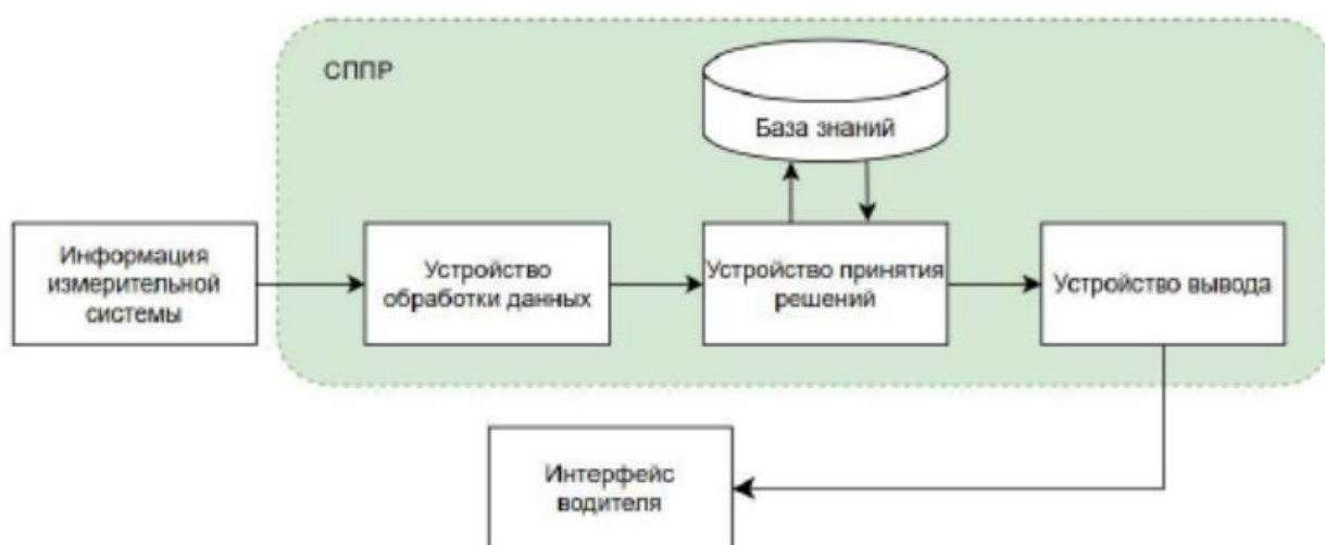
Рисунок 7 - Структурная схема системы поддержки принятия решений
