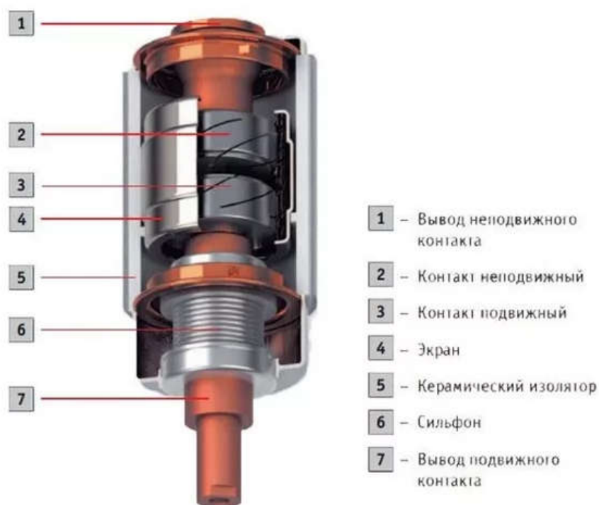
Рисунок 2.2.2 — Устройство вакуумной дугогасительной камеры
