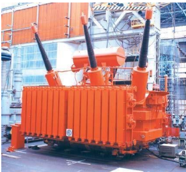
Рисунок 2.1.3 – Масляное охлаждение с дутьем и естественной циркуляцией масла
