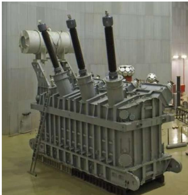
Рисунок 2.1.5 – Масляно-водяное охлаждение с принудительной циркуляцией масла
