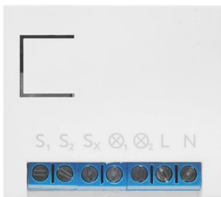
Рисунок 8 — Адаптер для управления розетками Redmond SkySocket 100.
