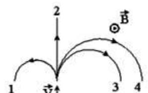
**6. На рисунке указаны траектории заряженных частиц, имеющих одинаковую скорость и влетающих в однородное магнитное поле, перпендикулярное плоскости чертежа. При этом для частицы 3 ...**
