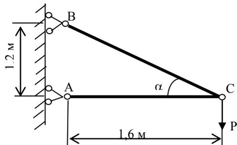
Стержень AC двутаврового поперечного сечения, стержень BC круглого поперечного сечения. Допускаемое напряжение для материала стержней  $[\sigma]=160$  МПа, модуль упругости  $E=2 \cdot 10^5$  МПа.
