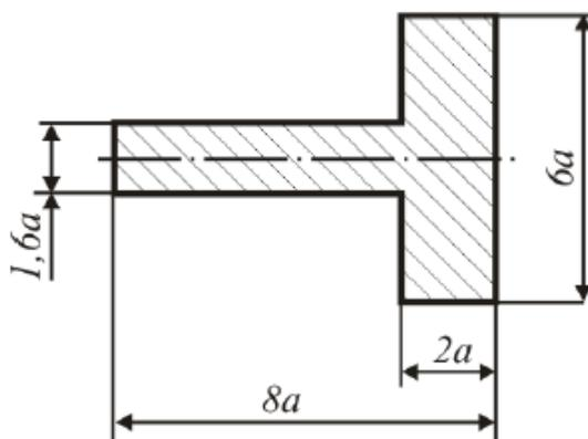
**Задание 3.** Для заданной балки из условия прочности по нормальным напряжениям определить размеры различных по форме поперечных сечений: двутавра, прямоугольника (с отношением сторон  $\frac{h}{b} = 1,8$ ), квадрата, круга, кольца
