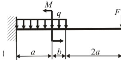
**Задание 4.** Для заданной стальной балки из условия прочности подобрать номер двутавра по ГОСТ 8239-89 и произвести полную проверку прочности.
