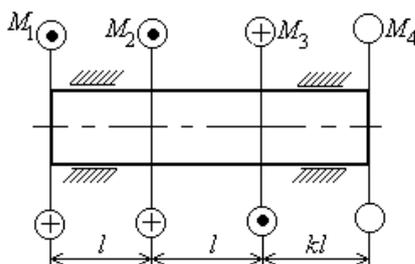
5. Для стального вала круглого поперечного сечения определить значение момента  $M_4$
