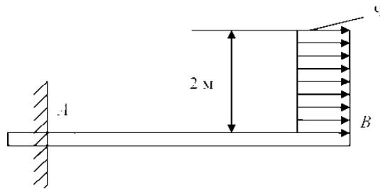
11. Если  $q=100\text{Н/м}$ ,  $AC=CB=1\text{м}$  то не учитывая вес бруса определить реакцию в точке В
