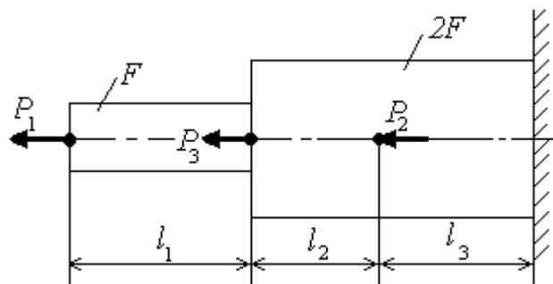
2. Определить нормальное напряжение на 2 участке. Материал стержня – сталь ( $[\sigma]=160$  МПа,  $E=2 \cdot 10^5$  МПа). Расчетная схема и числовые данные выбираются по рисунок  $F_2=1,6 F_1$ .
