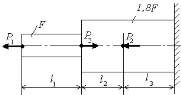
3. Проверить прочность и определить перемещение свободного конца стержня. Материал стержня – сталь ( $[\sigma]=160$  МПа,  $E=2 \cdot 10^5$  МПа). Расчетная схема и числовые данные выбираются по рисунку  $F_2=1,6 F_1$ .
