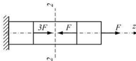
12 Максимальное напряжение в детали  $\sigma_{\max} = 100$  МПа. Известны механические характеристики материала детали: предел текучести на растяжение и сжатие  $\sigma_{TP} = \sigma_{TC} = 300$  МПа, предел прочности  $\sigma_{\sigma} = 500$  МПа. Фактический коэффициент запаса прочности равен \_\_\_\_\_
