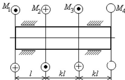
6. Для стального вала круглого поперечного сечения определить значение момента  $M_4$ :
