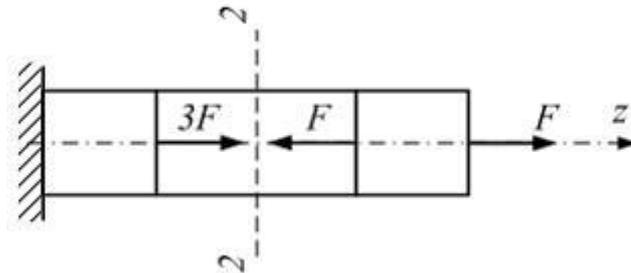
12 Максимальное напряжение в детали  $\sigma_{\max} = 100 \text{ МПа}$ . Известны механические характеристики материала детали: предел текучести на растяжение и сжатие  $\sigma_{TP} = \sigma_{TC} = 300 \text{ МПа}$ , предел прочности  $\sigma_s = 500 \text{ МПа}$ . Фактический коэффициент запаса прочности равен \_\_\_\_\_
