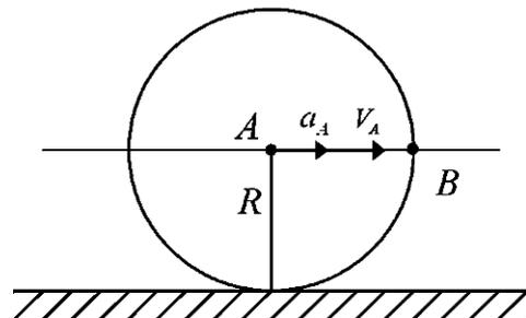
16. Точка движется с постоянной скоростью  $1\text{м/с}$  по ободу диска радиуса  $0,2\text{м}$ . Определить нормальное ускорение точки.
