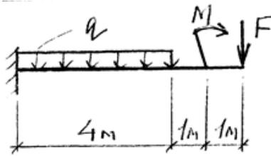
8. Для заданной двухпорной балки построить эпюры поперечных сил и изгибающих моментов, подобрать круглое сечение ( $d$  -?) из условия прочности по нормальным напряжениям, если  $[\sigma]=160 \text{ Н/мм}^2$ . Проверить жесткость выбранного сечения (с помощью формул), если модуль упругости  $E=2 \times 10^5 \text{ Н/мм}^2$ , а величина допустимого прогиба  $[f]=1/2001$ .
