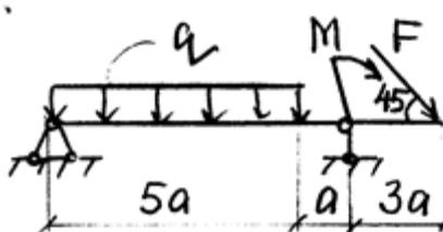
3. Определить реакции в опорах для рамы.
