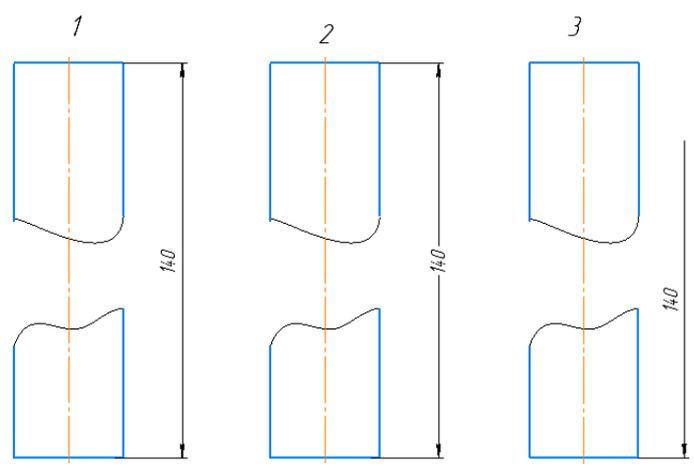
18. На каком чертеже размеры одинаковых элементов детали проставлены правильно?
