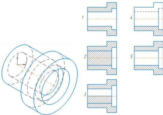
13. Местный разрез служит для уяснения устройства предмета в отдельном узко ограниченном месте. Граница местного разреза выделяется на виде сплошной \_\_\_\_\_ линией.
