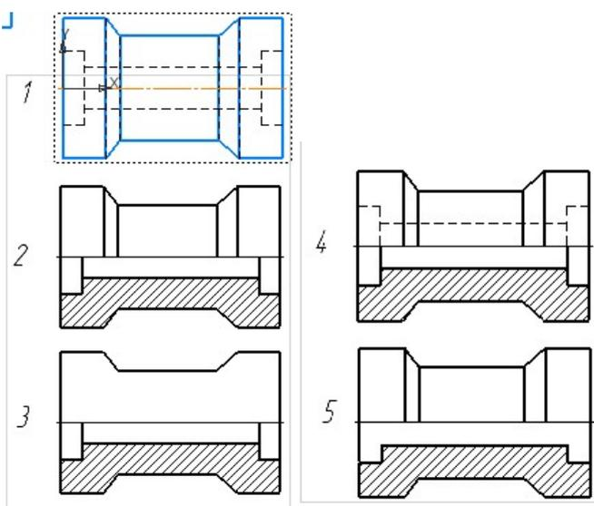
15. Определите, на каком чертеже правильно выполнено соединение половины вида и половины разреза для цилиндрической детали?
