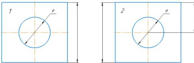
14. На каком рисунке размер диаметра окружности нанесен правильно?
