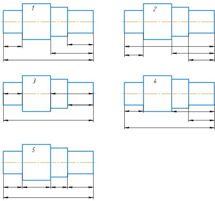
17. На каком чертеже размер длины детали нанесен правильно?
