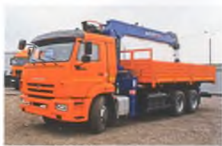
КМУ DY SS1956Aсе с грузоподъемностью, увеличенной до 8 тонн
