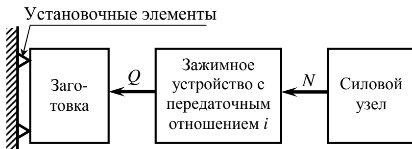
Рис. 2.8. Структурная схема закрепления заготовки:
