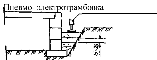
Рис. 3. Схема уплотнения грунта в пазухах наружных стен трамбованием
